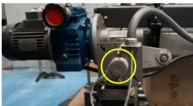
Figura 9 – Ilustración del Encoder instalado
