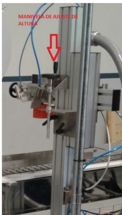
Figura 24. Ajuste de altura de sistema de activación de productos.
