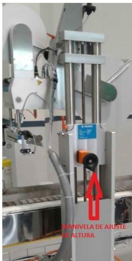
Figura 77. Ajuste de altura de etiquetas de acuerdo tamaño de productos.
