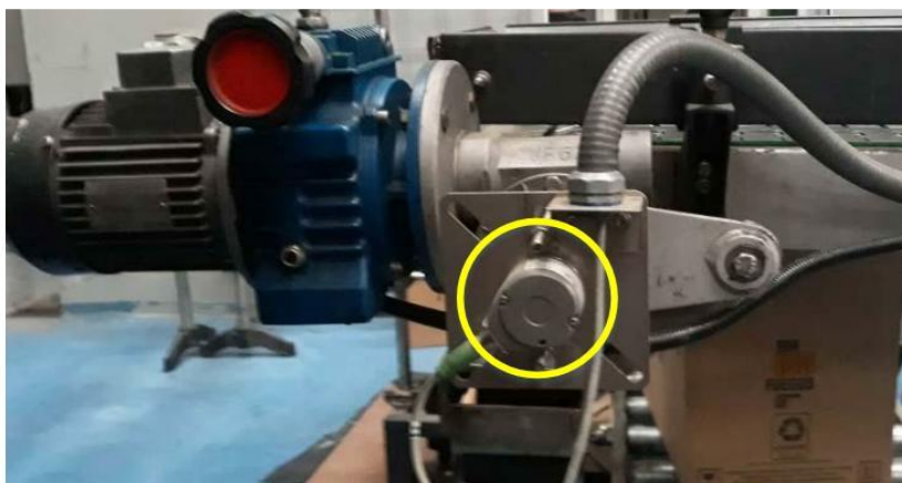
Figura 14 – Ilustración del Encoder instalado
