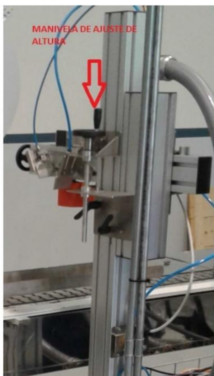
Figura 78. Ajuste de altura de sistema de activación de productos.
