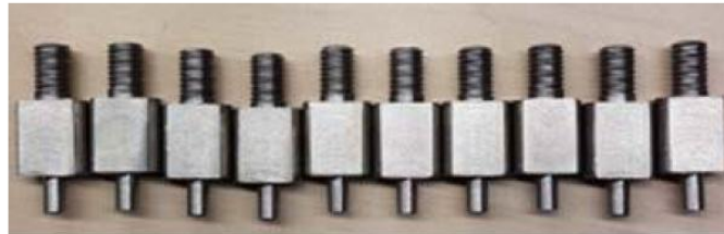
Figura 49 – Acoples Mecánicos (Machón) 8mm
