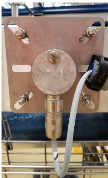
Figura 41 – Ilustración del Encoder instalado
