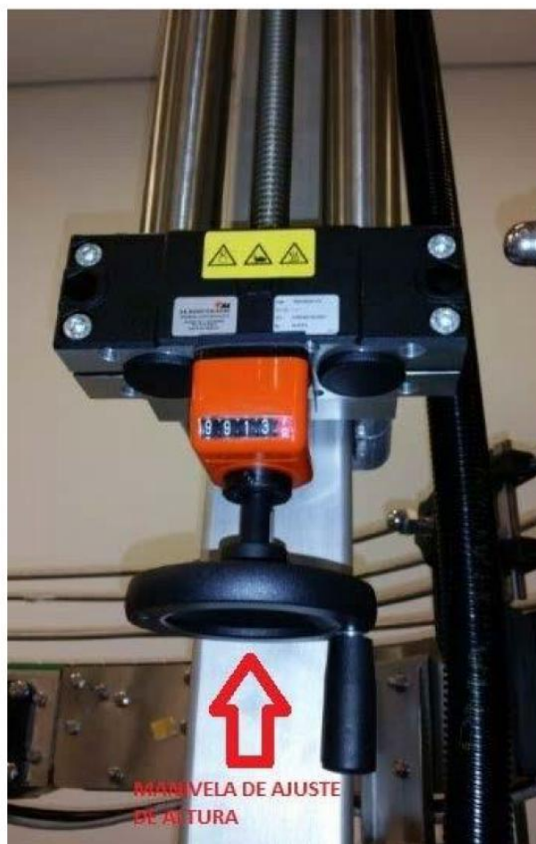
Figura 81. Ajuste de altura de sistema BEAM.
