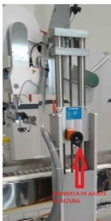
Figura 23. Ajuste de altura de etiquetas de acuerdo tamaño de productos.
